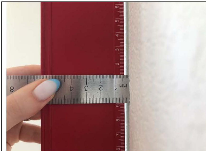
Фото №13. Измерение уровня стен детской в квартире.
