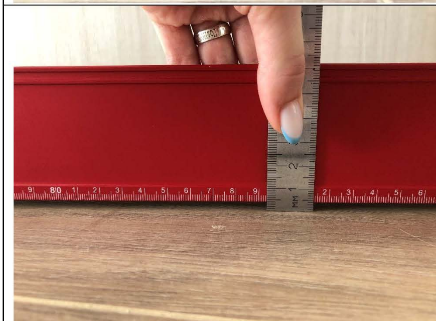
Фото №17. Измерение напольного покрытия коридора в квартире.
